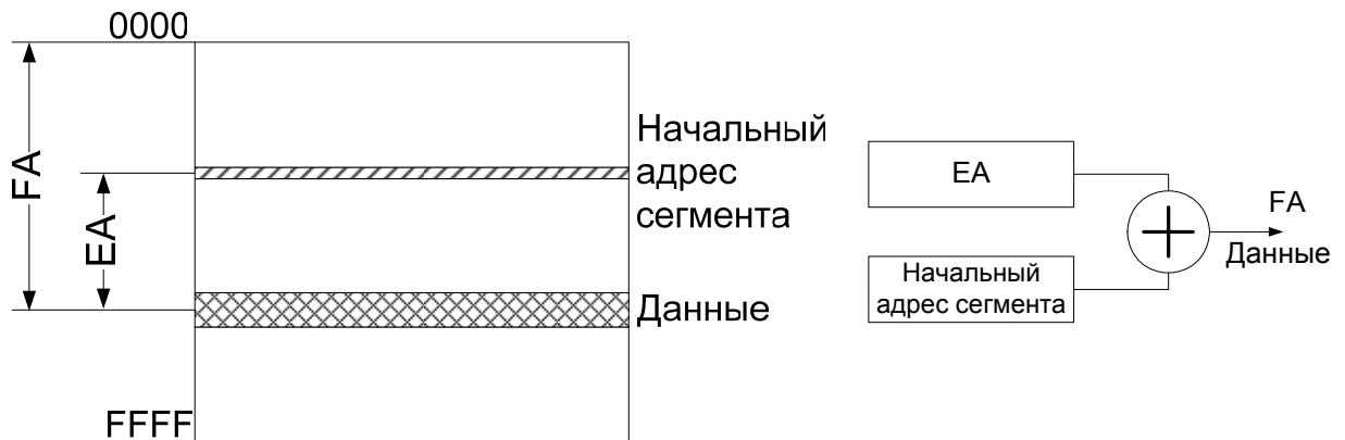
Рис. 9.4. Сегментная структура ВЗУ и вычисление FA
